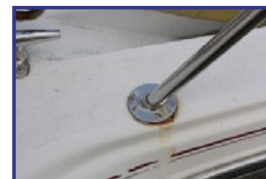
Rouille des accastillages ou autour de ceux-ci
